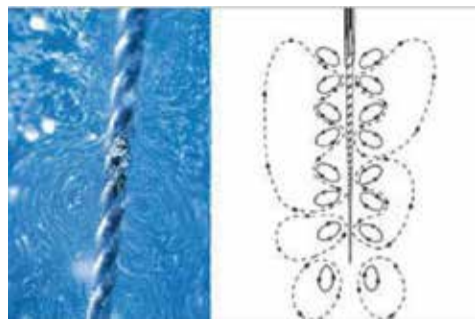
Εικ.4: Σχηματικό σχέδιο της ακουστικής ροής (acoustic streaming) γύρω από ένα μικροεργαλείο (Ahmad et al. 1987).
